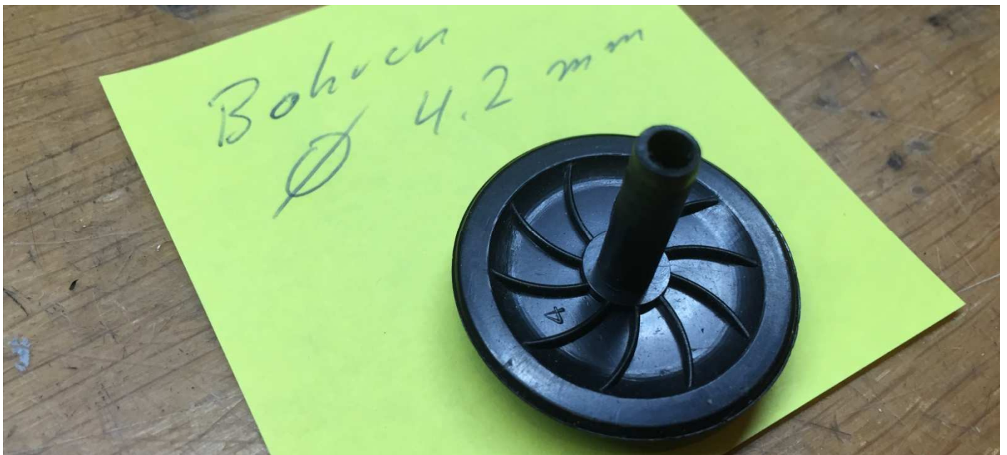
Bild 4) Beim nächsten Schritt müssen wir uns erst einmal Buchsen für die Piko Achslager herstellen. Diese fertigen wir aus alten LGB Radsätzen an. Es wird eine alte Achse auseinandergezogen und die hier gewonnenen Hülsen dann auf 4,2 mm Durchmesser aufgebohrt. Im nächsten Schritt sägen wir dann von der großen Hülse kleine Stücke von 4 mm Länge ab.
