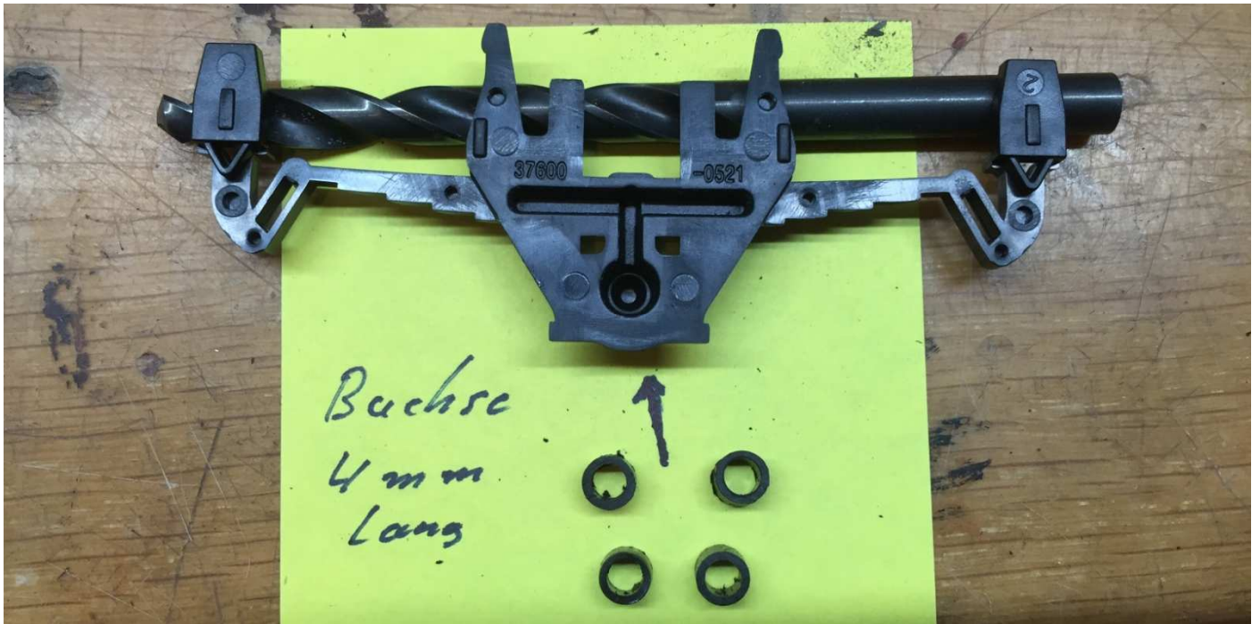
Bild 5) Auf diesem Bild sind die abgesägten Hülzen für die Piko Achslager gut zu erkennen.
