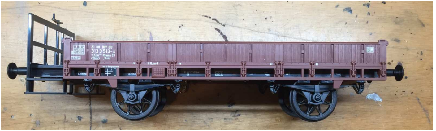
Bild 12) Dann den Wagen wieder zusammen bauen und schon ist man fertig mit dem Umspuren auf 64 mm Achsen.
